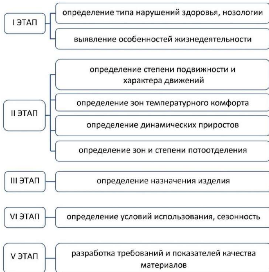
Рисунок 5.2 – Схема алгоритма выбора материалов для проектирования лечебно-профилактической и реабилитационной одежды
