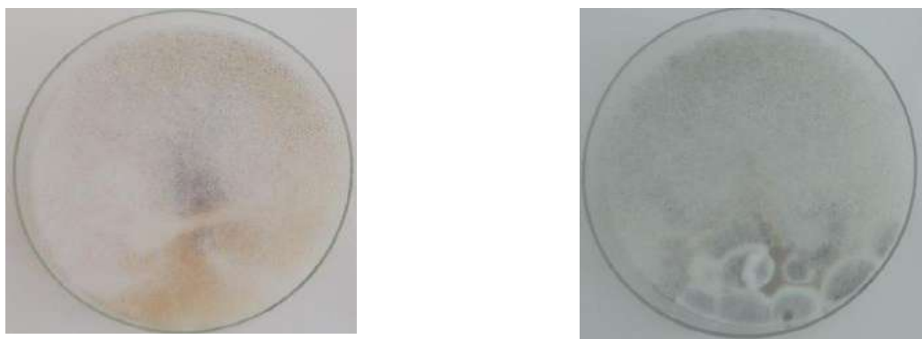
а б Рисунок 5.4 – Образцы материалов без антисептической обработки: а) вискозное полотно; б) полиамидное полотно
