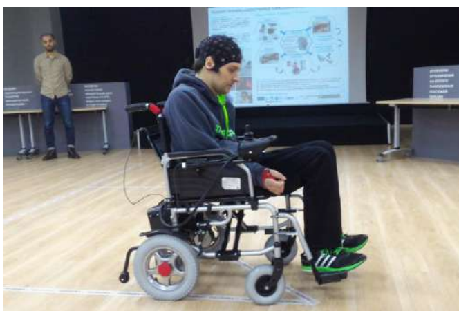
Рисунок 1.37 – Электрическая инвалидная коляска, управляемая нейроимпульсами [287]
