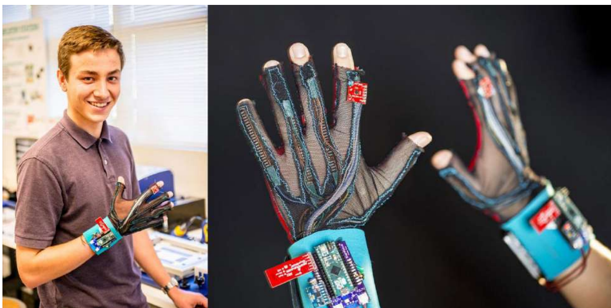
Рисунок 1.36 – «Умные» перчатки SignAloud для перевода речи жестами [554]
