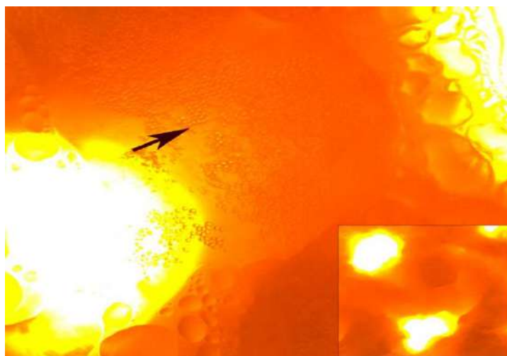
Рисунок 5.8 – Полиамидное полотно без пропитки, стрелкой указаны скопления дрожжевых колоний (увеличение x10, внизу x4)
